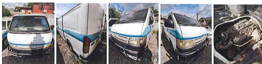
รูปถ่าย รายการที่ 15 รถยนต์ตู้นิรภัย TOYOTA รุ่น HIACE ECONOMY เครื่องดีเซล ขนาด 2494 CC.,ปี พ.ศ. 2550 หมายเลขทะเบียนรถ ตส 1496 รหัสรถ K-227 รหัสครุภัณฑ์ 50C0080418 (รถจอดอยู่ที่ศูนย์อุดรธานี) แบตเตอรี่เสื่อม .starท์ไม่ติด ใช้ลิ้นอยด์ปั๊มเชื้อเพลิงไม่ทำงาน ระบบเข็นทรัลล็อกชำรุด ขับเคลื่อนไม่ได้ ระบบปรับอากาศใช้งานไม่ได้ มีล้ออะไหล่ ไม่มีชุดเครื่องมือประจำรถ
