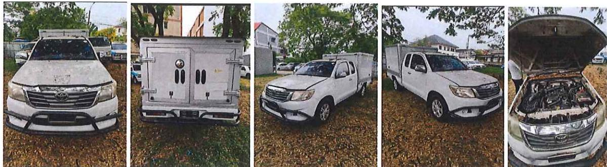
รูปถ่าย รายการที่ 21 รถยนต์ระบบ TOYOTA รุ่น HILUX VIGO CHAMP 2.7J Smart Cab แบบ TGN16R-URMDKT ติดตั้งตู้บรรทุกยี่ห้อ CARRYBOY พร้อมติดตั้งระบบแก๊ส LPG เบนซิน ขนาด 2694 CC. ,ปี พ.ศ. 2555 หมายเลขทะเบียนรถ หมายเลข 5132 รหัสรถ C-07 รหัสครุภัณฑ์ 55C0070040 (รถจอดอยู่ที่สำนักงานลาดพร้าว ล้านจอด 2) แบตเตอรี่เสื่อม มีชุดเครื่องมือประจำรถ มีล้ออะไหล่ สถาํารทติด ขับเคลื่อนได้ ระบบปรับอากาศใช้งานได้ ระบบเข็นทรัลล็อคใช้งานได้
