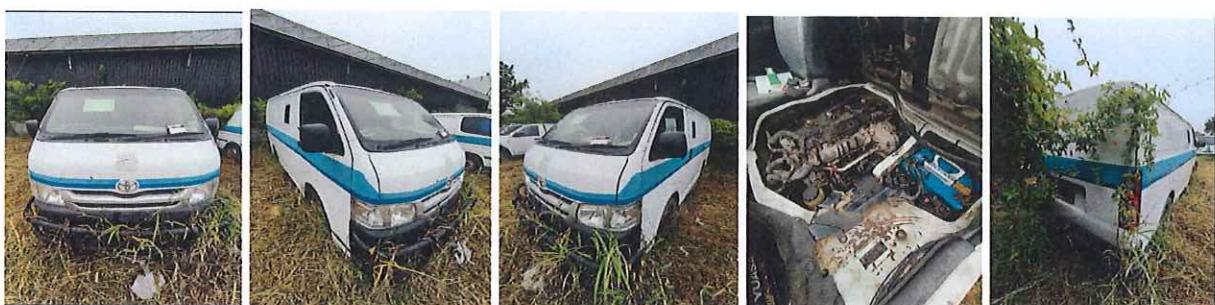
รูปถ่าย รายการที่ 33 รถยนต์กระบะนิรภัย TOYOTA HILUX TIGER Xtracab 3.0 SGL แบบ HILUX 4X2 หลังคา甫ปิดด้านข้าง-ท้าย เครื่องดีเซล ขนาด 2986 CC. ,ปี พ.ศ. 2543 หมายเลขทะเบียนรถ ลล 9092 รหัสรถ S-148 รหัสครุภัณฑ์ C008-0208/43 (รถจอดอยู่ที่ศูนย์บริการเงินสดกลางนครราชสีมา) แบตเตอรี่เสื่อม ไม่มีชุดเครื่องมือประจำรถ มีล้ออะไหล่ สตาร์ทติด ขับเคลื่อนได้ ระบบปรับอากาศใช้งานไม่ได้ ระบบเข็นทรัลล็อกใช้งานได้
