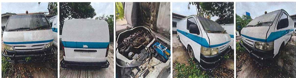
รูปถ่าย รายการที่ 18 รถยนต์กระบะนิรภัย TOYOTA HILUX TIGER Xtracab 3.0 SGL แบบ LN152R-CRMSST หลังคา甫ปิด ด้านข้าง-ท้าย เครื่องดีเซล ขนาด 2986 CC.,ปี พ.ศ. 2543 หมายเลขทะเบียนรถ ลง 9067 รหัสรถ S-117 รหัสครุภัณฑ์ C008-0183/43 (รถจอดอยู่ที่ศูนย์ขอนแก่น) แบตเตอรี่เสื่อม มีชุดเครื่องมือประจำรถ มีล้ออะไหล่ สตาร์ทไม่ติด ชุดปั๊มน้ำมันเข้าเพลิง ชำรุด ขับเคลื่อนไม่ได้ ระบบปรับอากาศใช้งานไม่ได้ ระบบเข็นทรัลล็อกใช้งานได้ ยางรถเสื่อมสภาพ แ朋ปิดในประตูซ้ายขวาชำรุด
