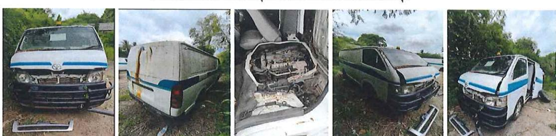
รูปถ่าย รายการที่ 16 รถยนต์ตู้นิรภัย TOYOTA รุ่น HIACE ECONOMY เครื่องดีเซล ขนาด 2494 CC. ปี พ.ศ. 2550 หมายเลขทะเบียนรถ ฒ 3818 รหัสรถ K-254 รหัสครุภัณฑ์ 50C0080444 (รถจอดอยู่ที่ศูนย์ขอนแก่น) แบตเตอรี่เสื่อม มีชุดเครื่องมือประจำรถ มีล้ออะไหล่ สตาร์ทไม่ติด ชุดสายไฟหัวฉีดสูบ 2 ชำรุดหัก ชิลล์ข้อเหวี่ยงหน้าหลังร้าว ขับเคลื่อนไม่ได้ ปั๊มคลัตช์บนร้าวระบบปรับอากาศใช้งานไม่ได้ ระบบเข็นทรัลล็อกใช้งานไม่ได้ ยางเสื่อมสภาพ
